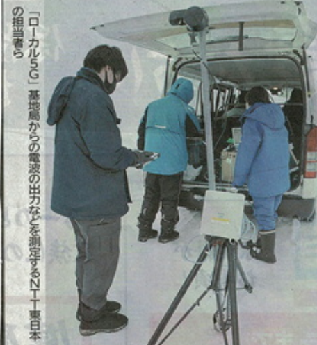
「ローカル5G」基地局からの電波の出力などを測定するN10車日本北道道庁
